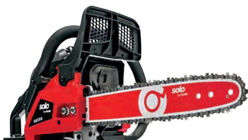
Con una lama da 40 cm e una catena da 3/8" spec., questa motosega compatta convince non solo per la sua potenza (1,5 kW / 40,1 cm<sup>3</sup>) e il sistema di avviamento rapido integrato, ma anche per la semplicità di manutenzione. Il filtro dell'aria, ad esempio, può essere sfilato e pulito con estrema facilità ed è possibile tendere la catena in un attimo attraverso l'apposito dispositivo laterale.
