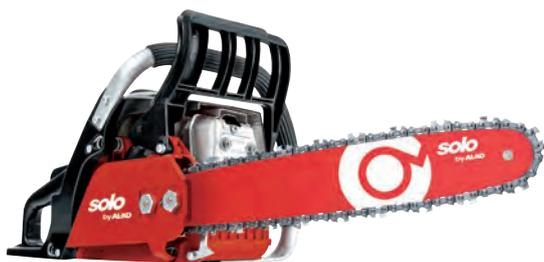
La potente motosega compatta da 1,5 kW, con cilindrata da 36,3 cm<sup>3</sup> e lunghezza barra da 35 cm, conquista non solo per la sua maneggevolezza e le sue prestazioni ma, grazie all'impugnatura professionale in alluminio, al sistema EasyStart, al dispositivo tendicatena laterale e alla lubrificazione catena automatica, offre anche molti altri vantaggi per gli utenti privati esigenti.
