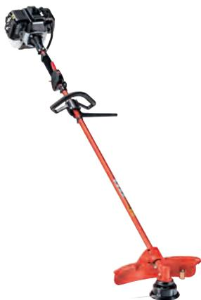
Questo decespugliatore base, leggero e maneggevole con la pratica impugnatura "loop", con una cilindrata di 25,4 cm<sup>3</sup> e una potenza di 0,75 kW, è ideale per tagliare e pulire erba alta e un sottobosco non troppo intricato. Il sistema EasyStart e l'innesto centrifugo garantiscono il regolare funzionamento, mentre l'ergonomia dell'impugnatura e il bilanciamento ottimale della macchina assicurano una postura naturale durante il lavoro.
